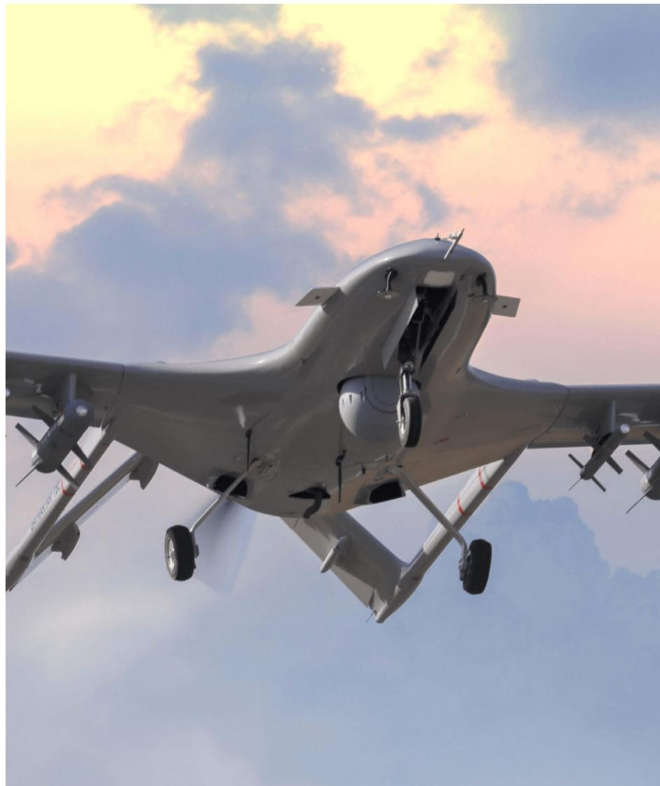
nasce da questi sforzi nel 2015 e diventa la produttrice principale di "velivoli lenti" tra cui il drone Tb2. Le caratteristiche tecniche del TB2 sono di interessante qualità: ha capacità visive notevolissime, può essere armato con quattro missili teleguidati e ad alta precisione, può volare in autonomia anche per ventotto ore, ma soprattutto è abbastanza semplice da utilizzare e costa molto meno di un drone israeliano o statunitense. È da tempo
