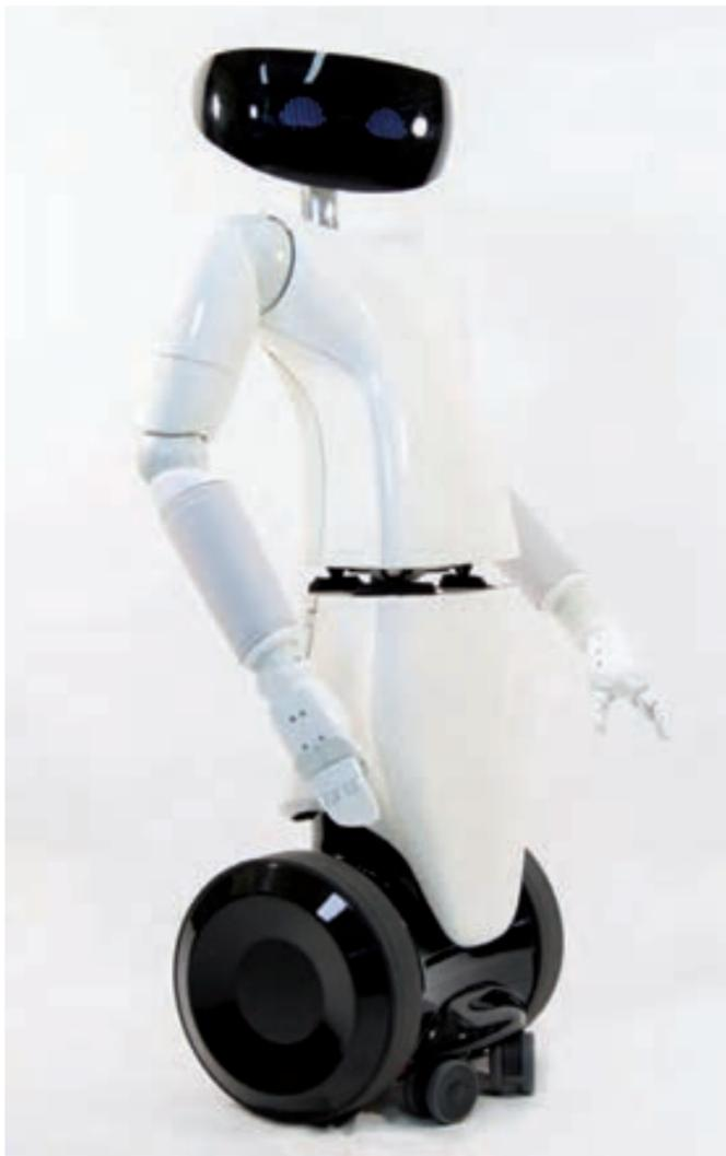
13 centimetri e mani rivestite di pelle artificiale in grado di regolare la pressione e afferrare gli oggetti senza provocare danni.
